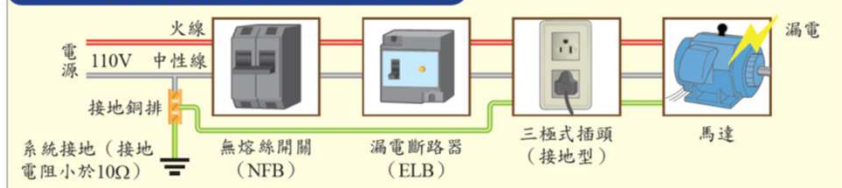
▲圖12-19 電器設備的接地
