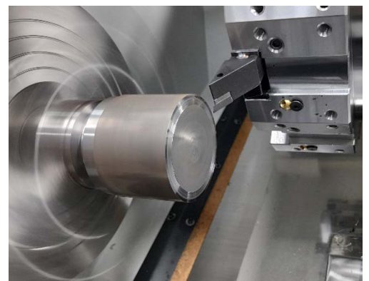
→ 模式選擇手輪並車削端面
