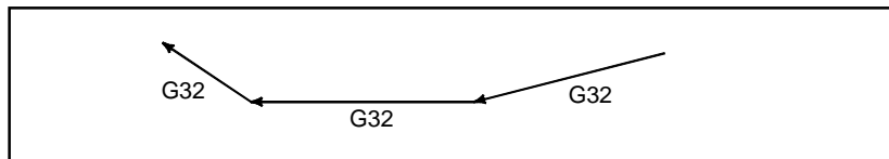
圖3.2 (a) 連續螺紋切削（G 代碼體系 A，G32 指令例）
